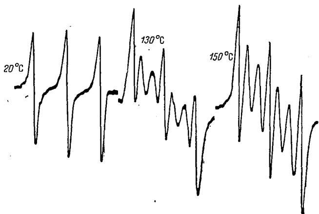
Рис. VIII. 17. Спектры ЭПР трирадикала I при разных температурах в бензоле [11].
