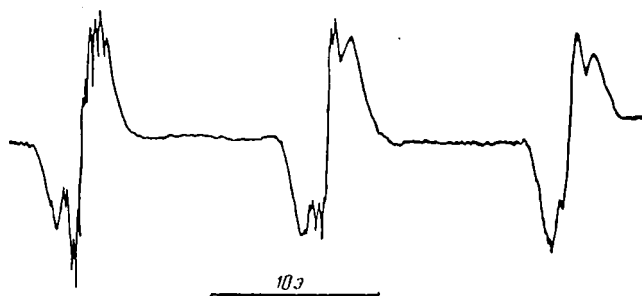
Рис. VIII. 15. Спектр ЭПР бирадикала \cdot\text{R}-\text{Ph}-\text{R}\cdot в бензоле; J/a \approx 0,3 [24].
