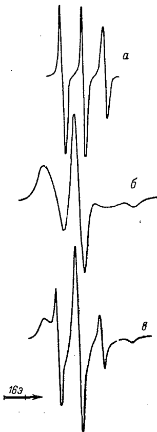
Рис. XI.6. Спектр ЭПР радикала I при 273 К в бутадиеновом каучуке (а), полистироле (б) и блоксополимере с содержанием стирола 50 вес. % (в).
